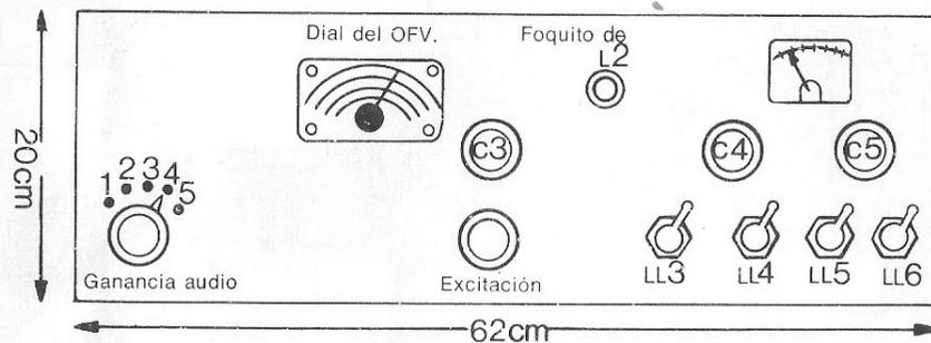
Fig. 44 - Vista del panel frontal del transmisor
