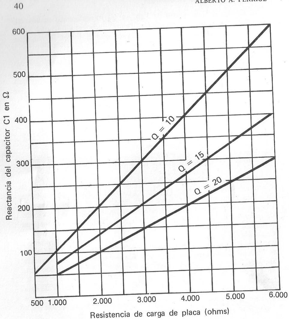
Fig. 21 - Gráfico que permite calcular el valor de C1 (Fig. 20) en función de la resistencia de carga
