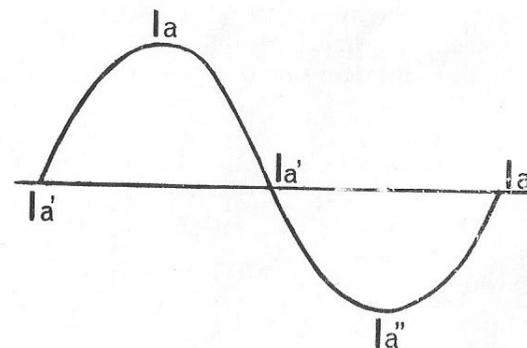
Fig. 12 - Resultado de las variaciones instantáneas de intensidad en el circuito anódico
