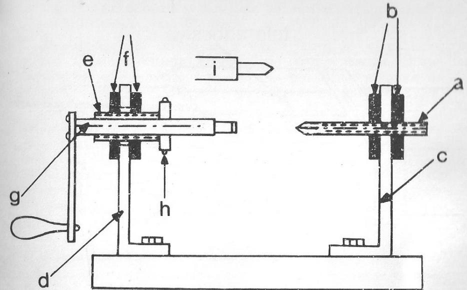
Fig. 35 - Sencilla máquina manual para bobinar
