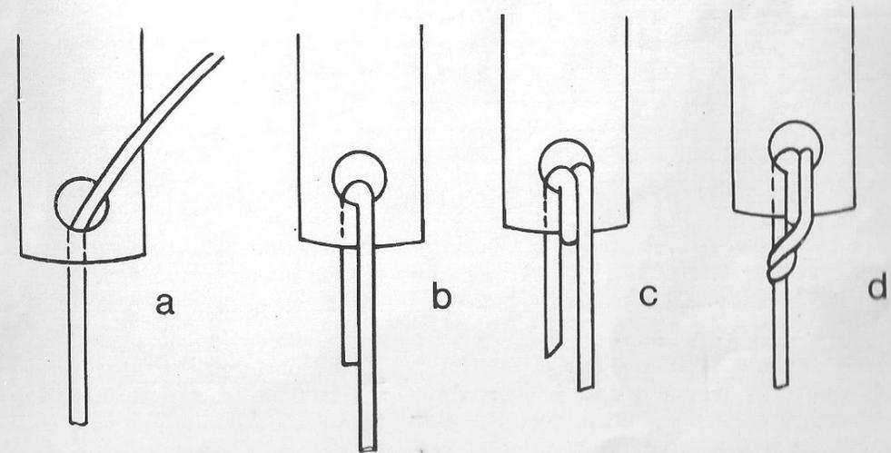
Fig. 6 - Cómo improvisar terminales para conexiones, en bobinas
