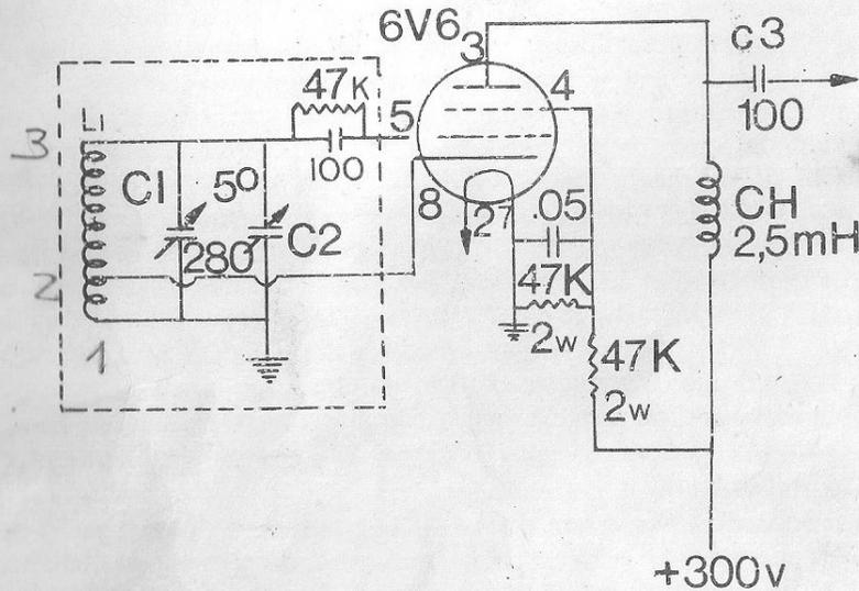
Fig. 3 - Esquema de conexiones de un oscilador de frecuencia variable. Es el que usaremos en nuestro equipo
