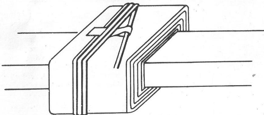
Fig. 37 - Cómo terminar el bobinado primario
