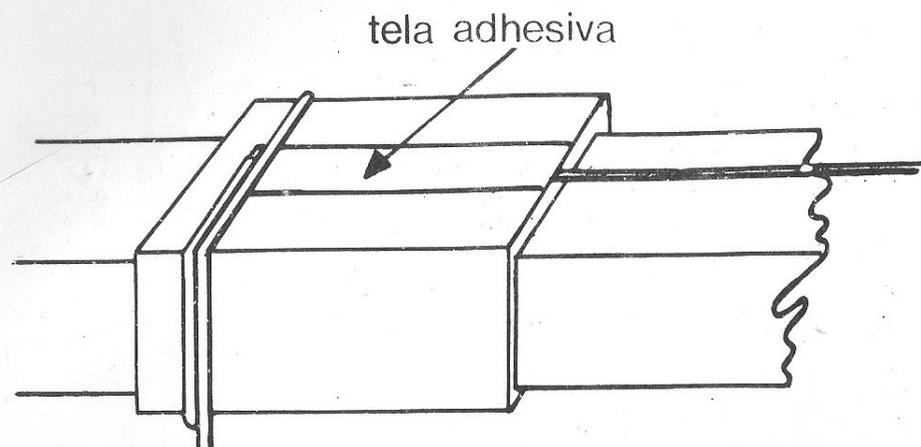
Fig. 36 - Detalle del comienzo del bobinado primario
